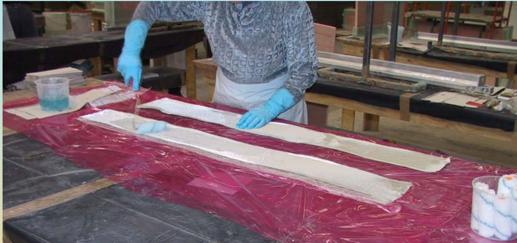
Einkleben einer Platte in einen Klebefalz eines Steges
